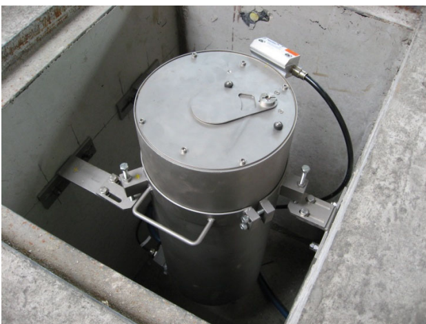
Abb. 3 Edelstahlgehäuse mit pneumatisch angetriebener Schutzklappe zum Schutz des Messgerätes, der Wandlerkomponenten und Sensoren im Messkopf
