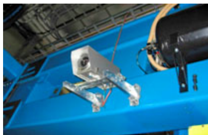
Abb. 4 IR Kamera 1 im Schutzgehäuse zur Messung vor dem Pressen
