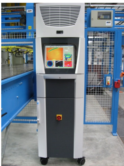
Abb. 1 Steuer- und Auswerteeinheit zur Bedienung der Kameras an der Presse und Übermittlung der Auswertung an die Pressensteuerung
