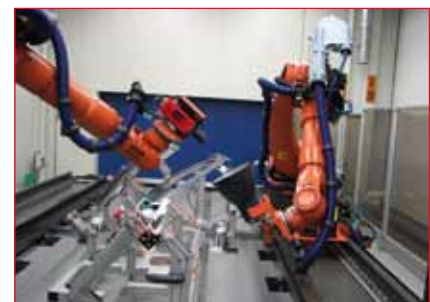
Thermografiekamera und Industrieblick in Prüfposition
