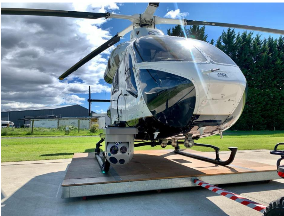
Abb. 4: Bell 206-1 LongRanger mit GIMBAL-System inklusive VarioCAM® HD head 800
