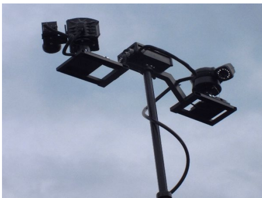
CCTV-System mit Wärmebildkamera VarioCAM® hr head 620
